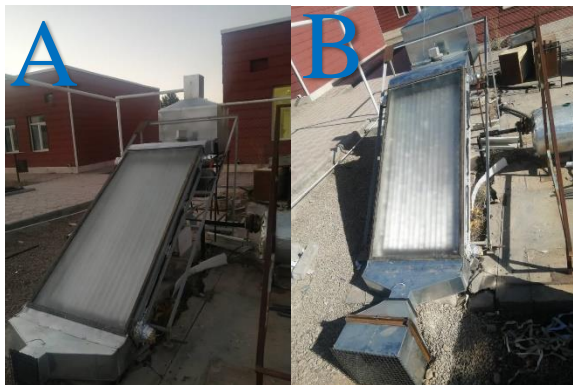
شکل ۵: حالت مونتاژ شده سیستم، (A) سیستم در حالت جایجایی آزاد، (B) سیستم در حالت جایجایی اجباری
